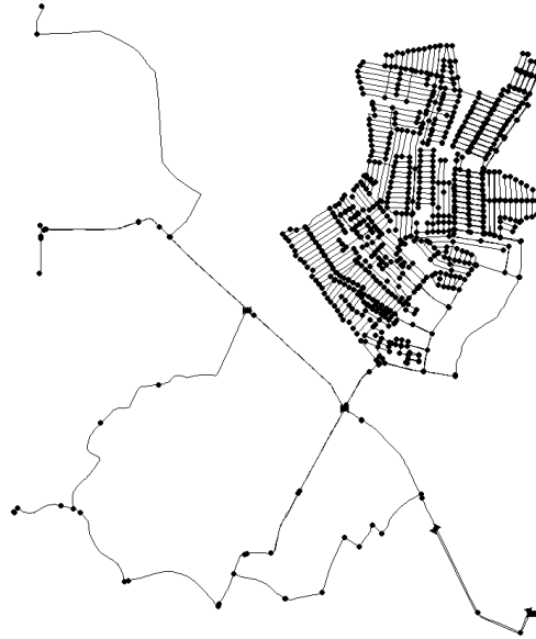
Fig 1. EPANET Modeling Banua Anyar Booster
